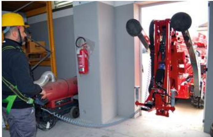
Hauteur de transport **inférieur à 2 mètres** pour permettre le passage d'une porte standard.
