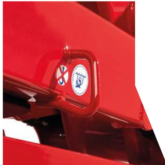
**Crochets d'ancrage Heavy Duty.**
