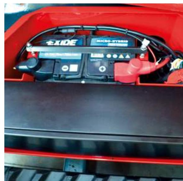
**Batterie principale de type AGM** pour start&stop, avec maintien de charge.
